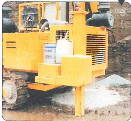
Ein Stützzylinder, der den Namen wirklich verdient. Leicht seitlich versetzt angeordnet, steht er richtig zur Lafette und zum Schwerpunkt des Bohrgerätes.
