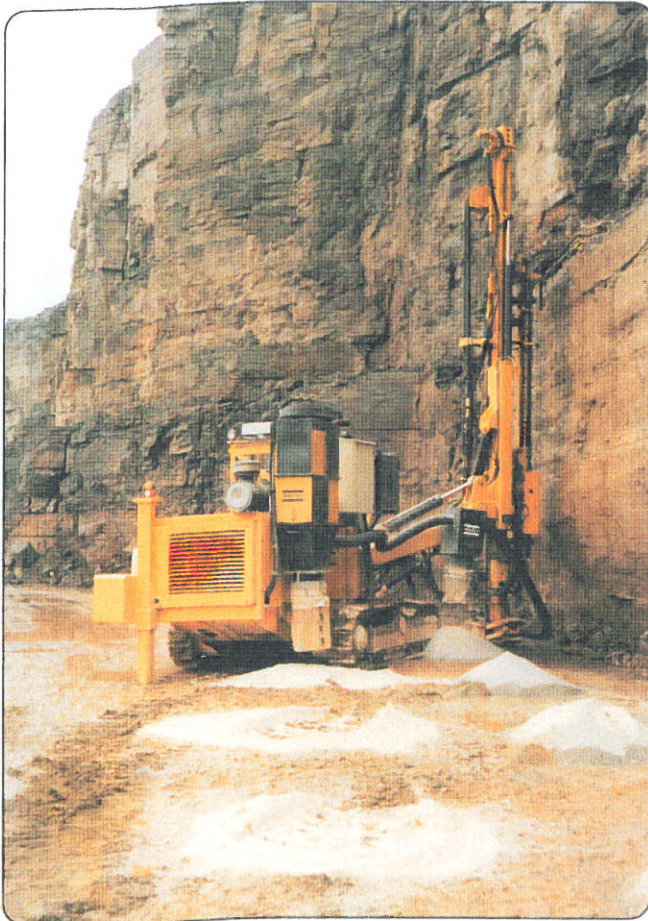
Optimale Zugänglichkeit: Bohrungen beispielsweise sehr nahe an der Strossenwand sind kein Problem. Beachten Sie die Wirksamkeit des Vorabscheiders am Ausleger.
