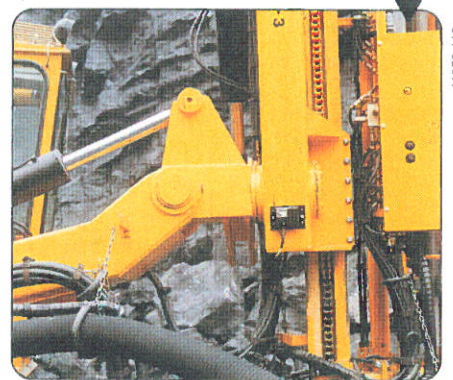
Ein Stützzylinder, der den Namen wirklich verdient. Leicht seitlich versetzt angeordnet, steht er richtig zur Lafette und zum Schwerpunkt des Bohrgerätes.
