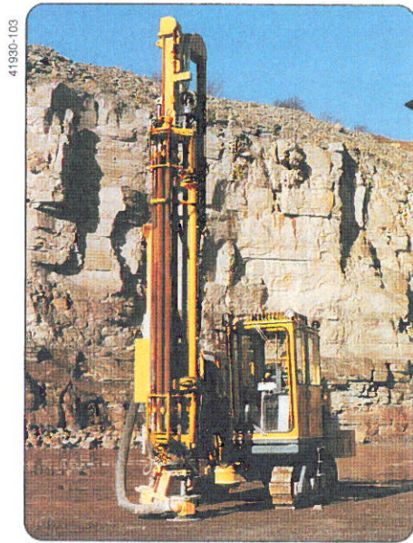
Ein Stützzylinder, der den Namen wirklich verdient. Leicht seitlich versetzt angeordnet, steht er richtig zur Lafette und zum Schwerpunkt des Bohrgerätes.
